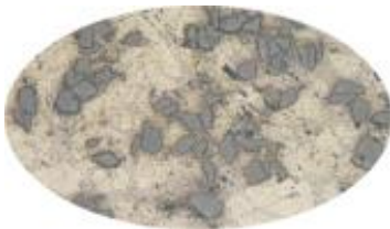
Kompozyt metalowo-ceramiczny (silumin z SiC)
